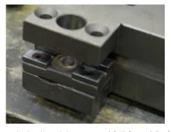
Carefully remove the hardmetal. Pozor, nesmí dojít ke ztrátě talířových pružin.
